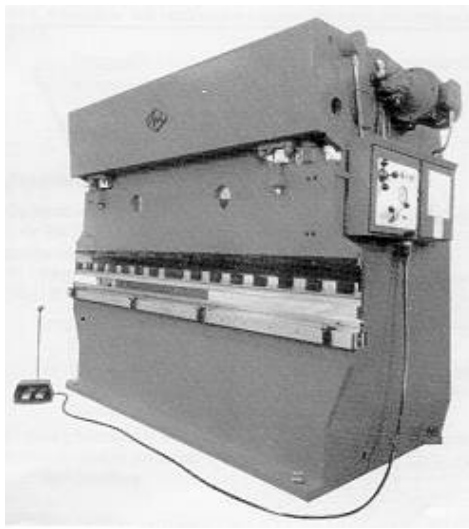
Fig. 1: Principales órganos constitutivos de una prensa plegadora
